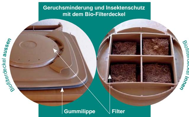
Alle Biotonnen im Landkreis Waldshut sind mit Biofilterdeckeln ausgestattet, um Geruchsbelästigungen zu verringern. Im Biofilterdeckel befindet sich ein Substrat aus Kokosfasern und anderen Stoffen, welche – aktiviert durch einmalige Zugabe von Wasser – schlechte Gerüche filtern, sodass diese bei geschlossenem Deckel nicht nach außen dringen können.
